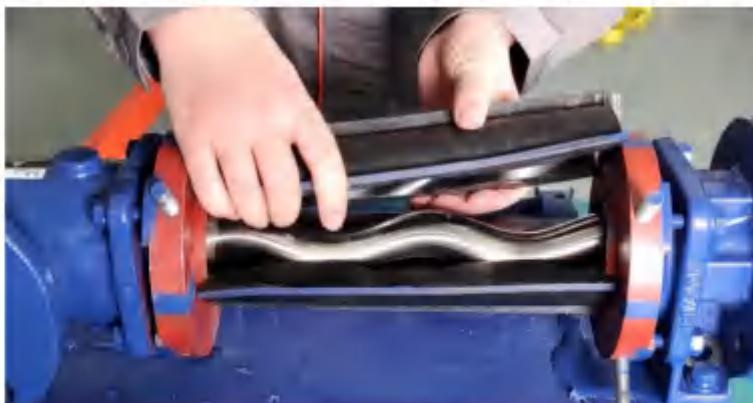
10. 向泵体一侧，拉开减速机轴与传动轴连接处的橡胶挡套，并取下传动销。
