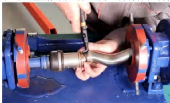
13. 取下转子上的密封圈，并检查其老化状况。
