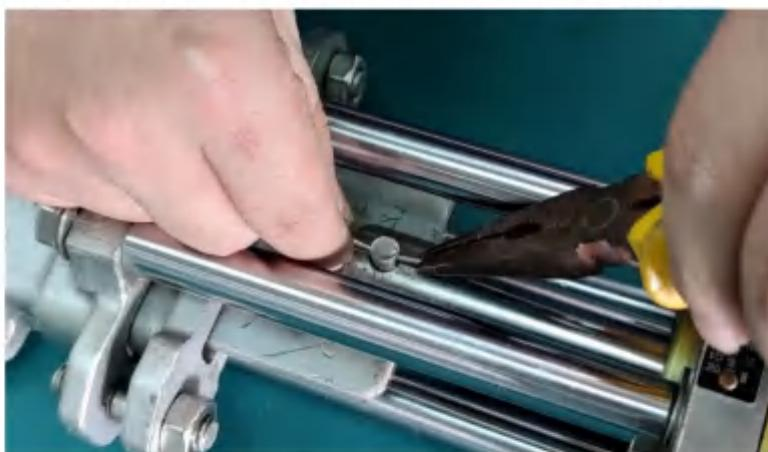
10. 松开气缸支架螺丝，将气缸与阀座分离。
