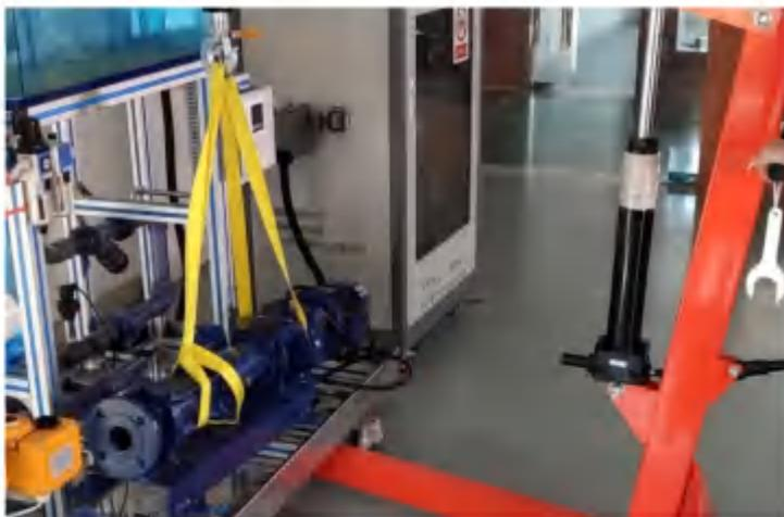
8. 拆卸螺杆泵上进出口法兰，清洁并检查法兰密封垫的完整性。
