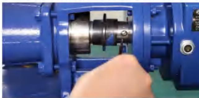
11. 握紧转子，用力往外拉，直至转子与传动轴连接处暴露出来。
