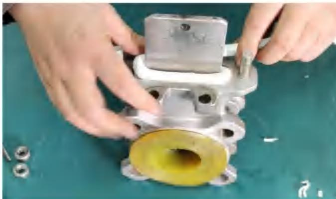
16. 压上压盖，均匀地锁紧螺母，将填料慢慢压入缝隙中。
