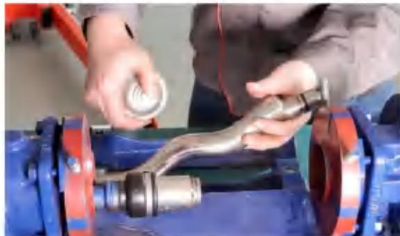
15. 组装时，应反向依次组装。注意：橡胶定子有字母的一端应在同一侧。同时，锁紧定子压紧盖时要均匀用力，保证定子之间严丝合缝，无可见缝隙。
