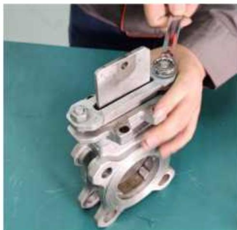
12. 用盘根取出器取下旧的盘根后，拉出阀板。
