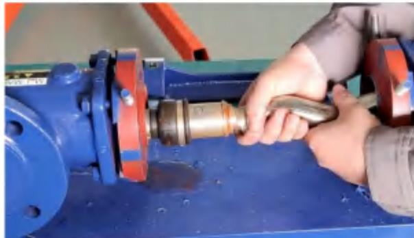
12. 用卡簧钳卸下卡簧，取出金属挡圈，跳出销子，并将转子与传动轴分离开来。
