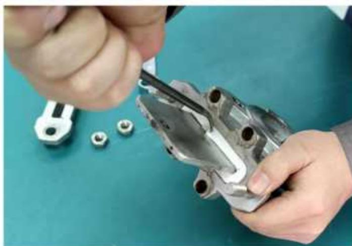
13. 将卸下的器件有序地摆放在工作台上，依次组装用 WD-40 保养好的零部件。
