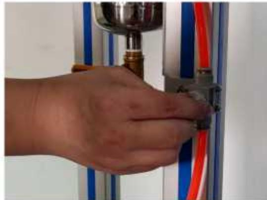
5. 关闭手动蝶阀，打开排气阀和隔膜阀，并用水桶从管道最低处的放空阀门中清空余水。
