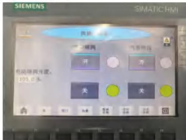
8、阀门设置好后，进入泵操作界面，设置好变频器频率，然后点击运行，水泵会按照设置的频率运行，运行过程中可修改变频器频率，停止时只需要点击停止按钮即可。测试水泵时，应选取 50Hz、40Hz、30Hz、20Hz 这几个工况，分别检测它们所对应的流量，查看两者是否存在一定的线性关系。
